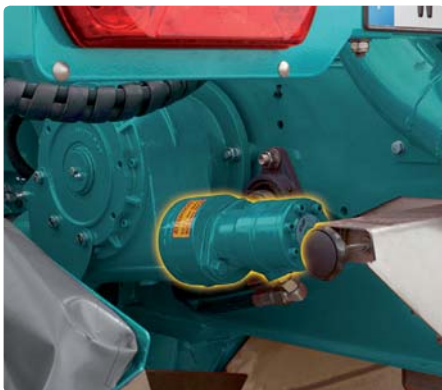
быстрое гидравлическое опустошения для очистки бункера когда работа завершена (опция)
