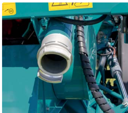
Трубы для заполнения для шнековой версии (опция) и гидравлический шнек (стандарт)
