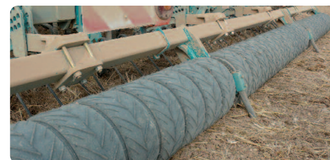
Прикатывание: благодаря цельному катку Farmflex® (360 мм диаметр), сеялка Kronos, даёт возможность экономить время на после посевное прикатывание! Управляемый гребенный загартач входит в стандартное оснащение.
