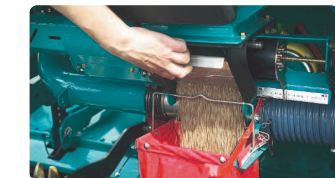
Экономия времени: Центральное расположение рабочих органов системы ADS позволяет производить быстрое тестирование нормы и полное опорожнение бункера.
