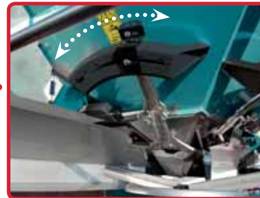
Электрическая настройка из кабины трактора (версия ECONOV)
