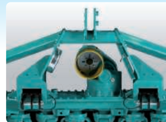
3-Моноблочное прицепное устройство для возможности работы с сеялками с большой ёмкостью бункера
