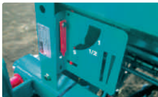
Индикатор уровня загрузки бункера, уровня сеялки и технологической колеи
