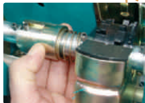
Отключение высева половины сеялки для оптимизации Ваших проходов и внесения семян
