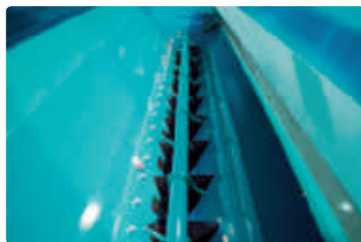
Основание бункера с разделительной пластиной для использования всего объема семян, медленно-вращающийся мешатель и уплотняющая пластина для равномерного расхода семян
