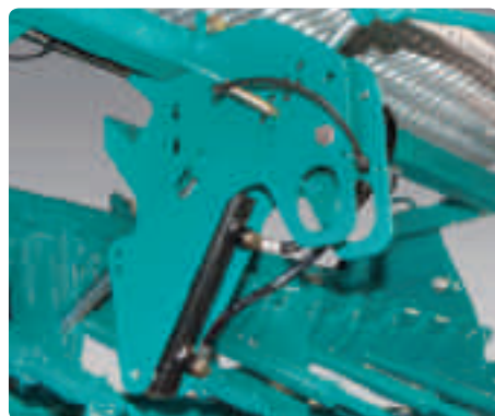
Изменение глубины посева с помощью гидравлики (опция)
