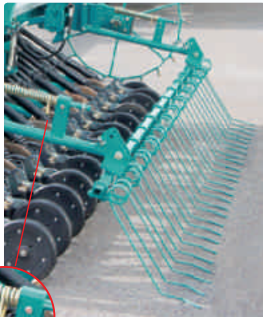
Загартачи с изогнутыми зубцами с удобной рукояткой для настройки и еще более прочные шарниры
