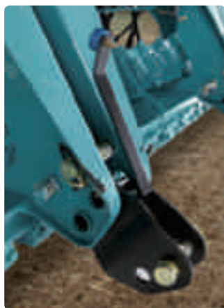
Указатель технологической колеи без наличия маркера (опция) и плавающая сцепка (опция)
