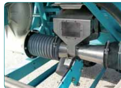
Дозатор из нерж. стали для семян или удобрений
