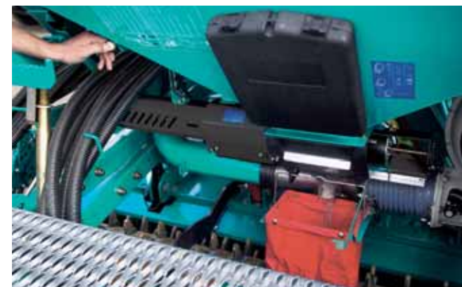
Дозатор SULKY может использоваться, как при работе в поле, так и при регулировках перед работой. Для проверки калибровки нет необходимости что-либо демонтировать, все регулировки расположены вокруг дозатора.
