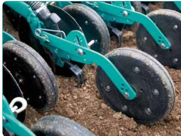
Прикатывающий каток диаметром 40 мм с 8 положениями регулировки, в т.ч. быстрой уборки; только для рядового посева UNIDISC (LS 2.30).
