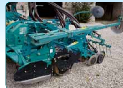
Боковые складные маркеры установленные на роторный культиватор; они оснащены пассивной защитой (болт на срез), а так же активной защитой с гибким зубцом, оставляют след по центру трактора
