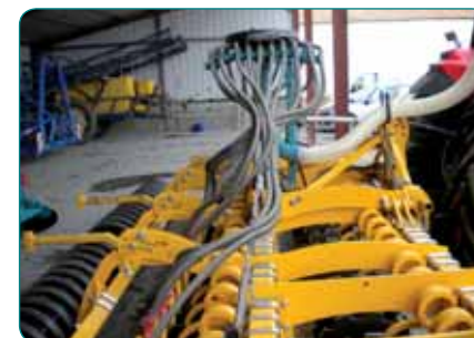
Распределительная головка с деталями из нержавеющей стали для посева растительного покрова (устанавливается на дисковую борону) или внесения удобрений (для сеялок точного посева).
