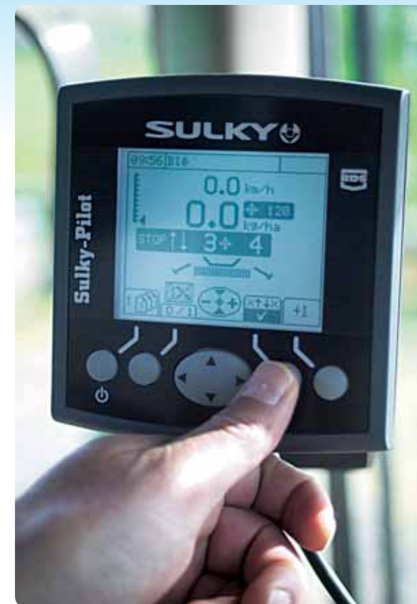
Электронный пульт PILOT с большим дисплеем с подсветкой.
