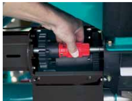
Универсальный дозатор: переход от маленьких семян к большому путем простого переключения кулачковой муфты
