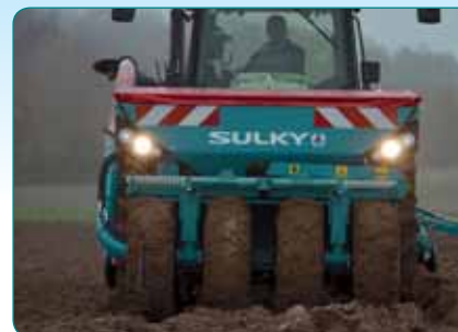
Рабочие светодиодные фары с независимым управлением. Дорожное освещение и светоотражатели (фары ближнего света, поворотники, габаритные фары).
