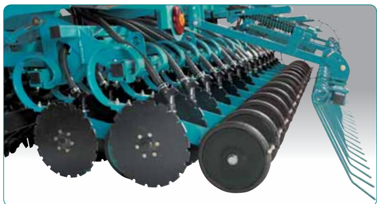
CULTIDISC « 80 кг » : от компании SULKY : заглубление в любых условиях, которое к тому же предоставляет расстояния между рядами в 560 мм !
