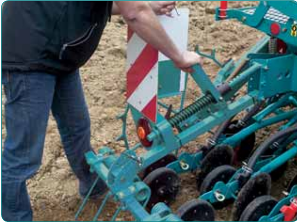
Гребенчатая борона для оптимальной заделки засеянных рядков; новые возможности для регулировки давления и наклона, позволяющие работать в любых условиях. Прямые или нивелировочные зубья, в зависимости от модели. Прямые зубья: ○ MD - HD - TF Нивелировочные зубья: ○ MD - HD - PRO - TF
