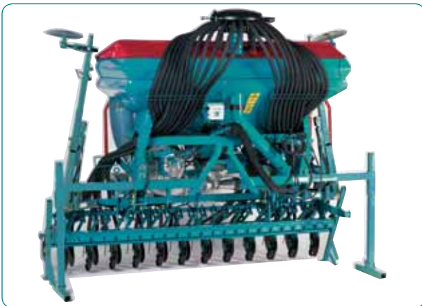
Подставки для хранения для упрощения сцепления и отцепления, при необходимости, вращающейся бороны сеялки.
