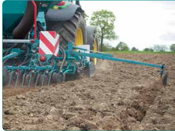
Боковые разметчики с гидравлическим подъемом в вертикальное положение, установленные либо на сеялке XEOS, либо, для максимальной интеграции, на бороне CULTILINE (Горизонтальное складывание на складной модели TF).
